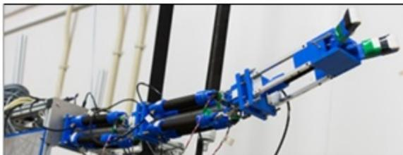
空気圧ゴム人工筋を用いたロボットアーム
