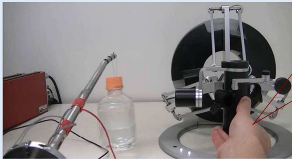
(a) ハプティックデバイスによる 多自由度ロボット鉗子の力覚制御
