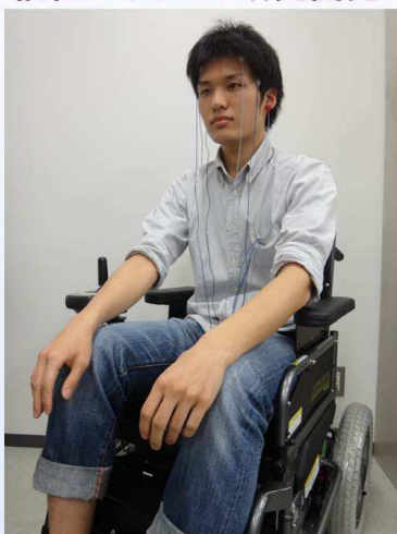
(e) 脳波による電動車椅子の制御
