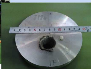
アルミニウム合金に ナイロン球（直径約7mm、0.2g） を秒速約7kmで衝突
