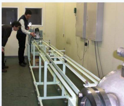
航空機材料へのバードストライク （鳥衝突）試験装置
