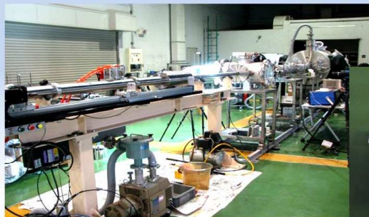
スペースデブリ衝突試験機 2段式軽ガスガン(JAXA宇宙研)
