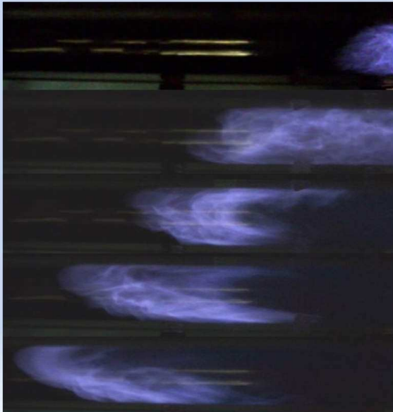
乱れを伴う管内進行火炎伝播 (ガソリン機関内燃焼模擬実験)
